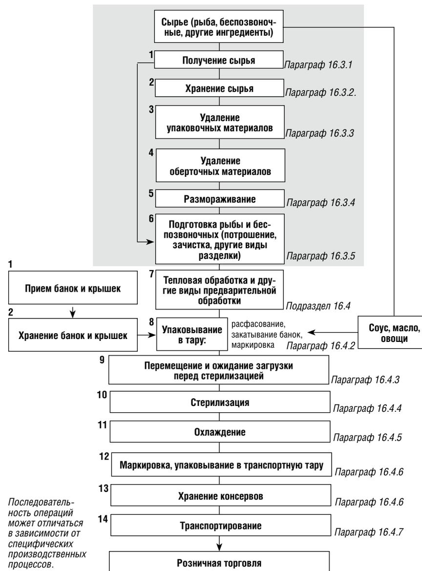
Рисунок 16.1. Пример схемы процесса производства консервов из рыбы и беспозвоночных.
